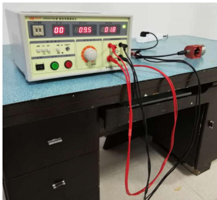
测试结果：安全门开关内部电路线路板上相邻两导线间回线电阻值范围为 0.84-0.97 欧，符合标准规定。
