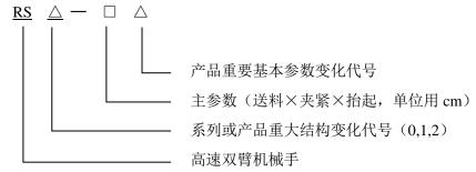
示例: RS-320×110×50——送料 320cm 夹紧 110cm 抬起 50cm 的热成形生产线用高速双臂机械手。
