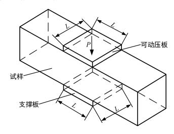
图 1 抗压强度试验
